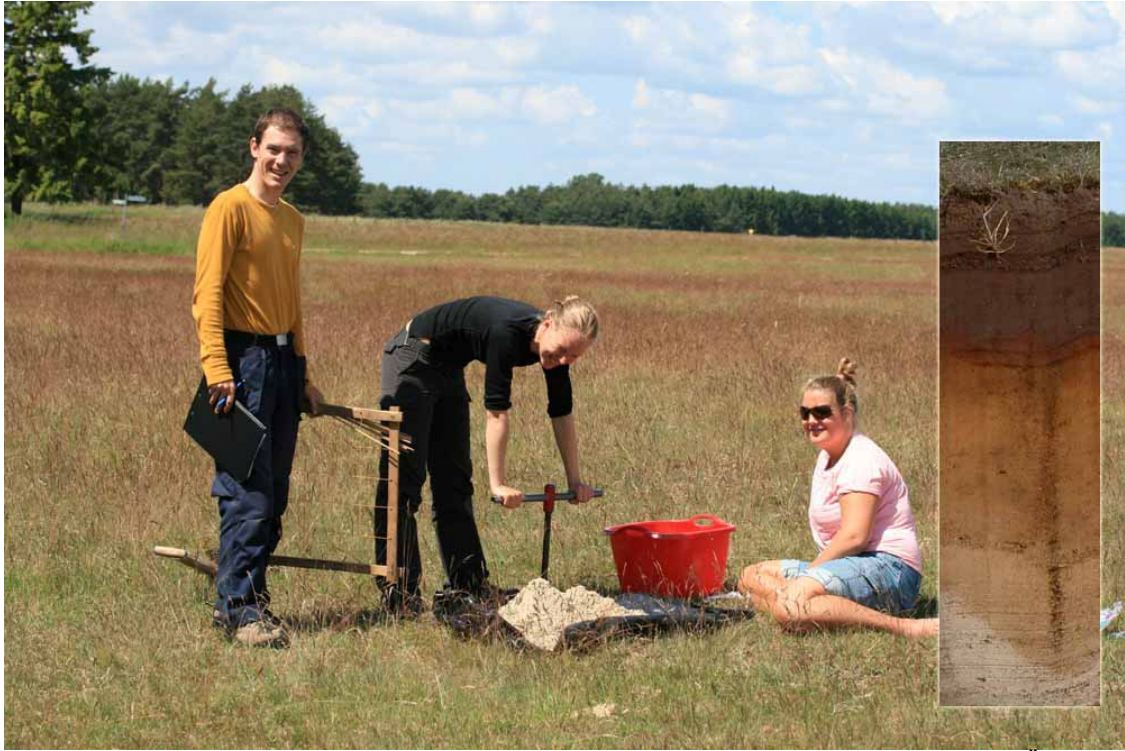
Undersökningar i sandstäppen. Infälld bild visar en typisk jordprofil för försurad sandmark. Överst ett humusberikat matjordsskikt, därefter ett ljusbrunt skikt av försurad sand och längst ner kalkrik sand.
